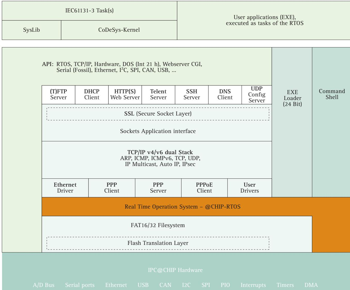
**Bild 2.** Das Architekturbild gibt eine Übersicht über die einzelnen Softwarepakete
