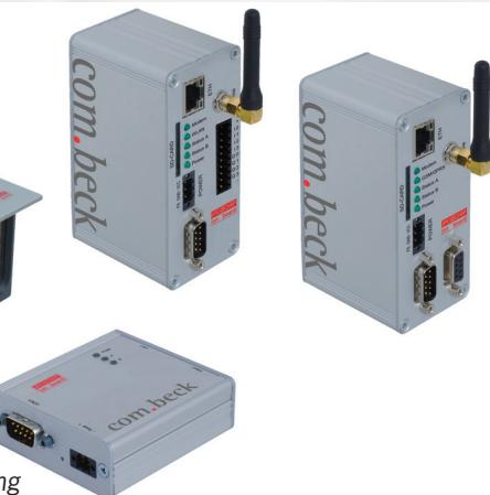
Mit der Prozesseite wird über eine serielle Schnittstelle oder über digitale Ein- und Ausgänge kommuniziert. Die lokalen digitalen Ein- und Ausgänge können zusätzlich mit einfachen SPS-Funktionen verknüpft werden. Auf dem Webserver des „com.tom“-Basic befindet sich der Web-basierte Editor Web-PLC für kleine Ablaufsteuerungen.
